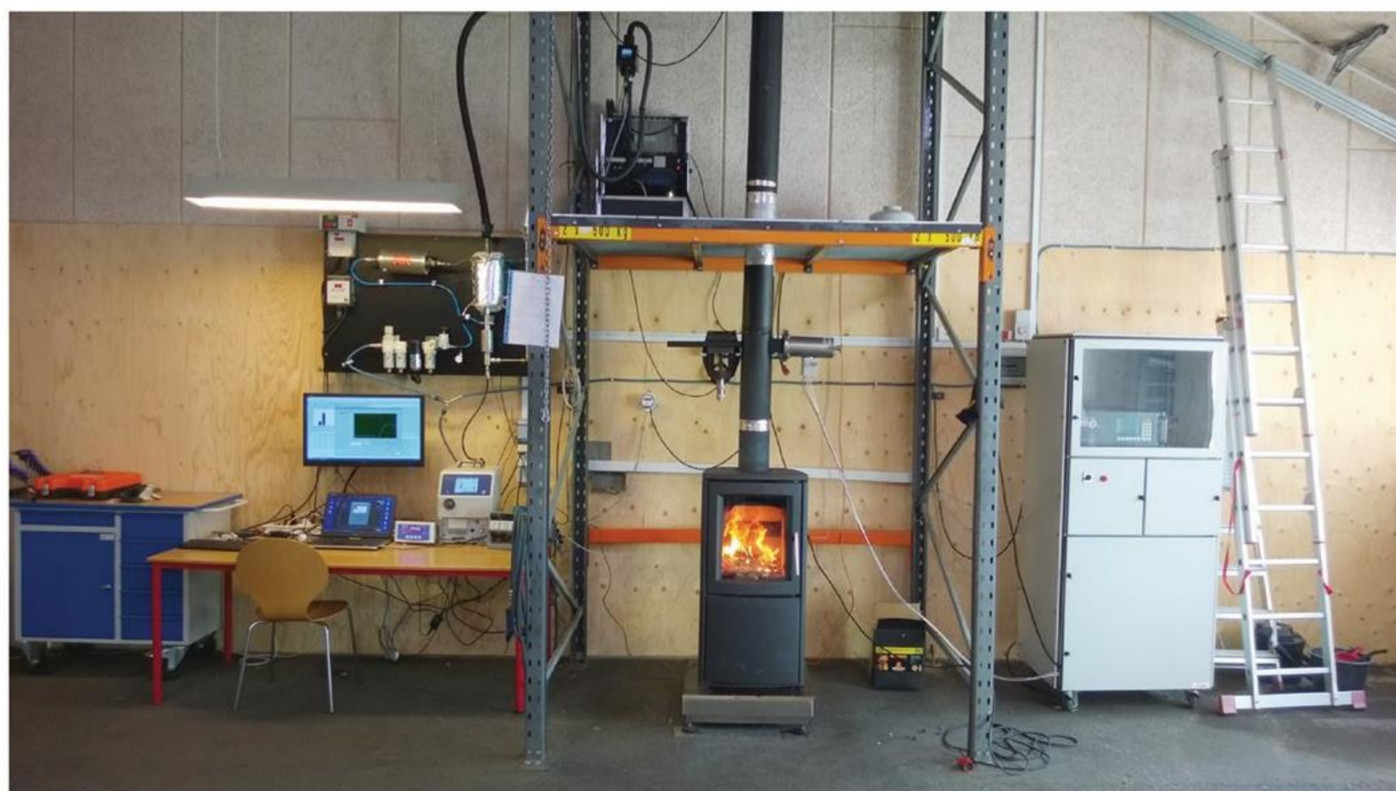
Figur 5. Stor målestand til måling af emission til udeluften fra en brændeovn.
